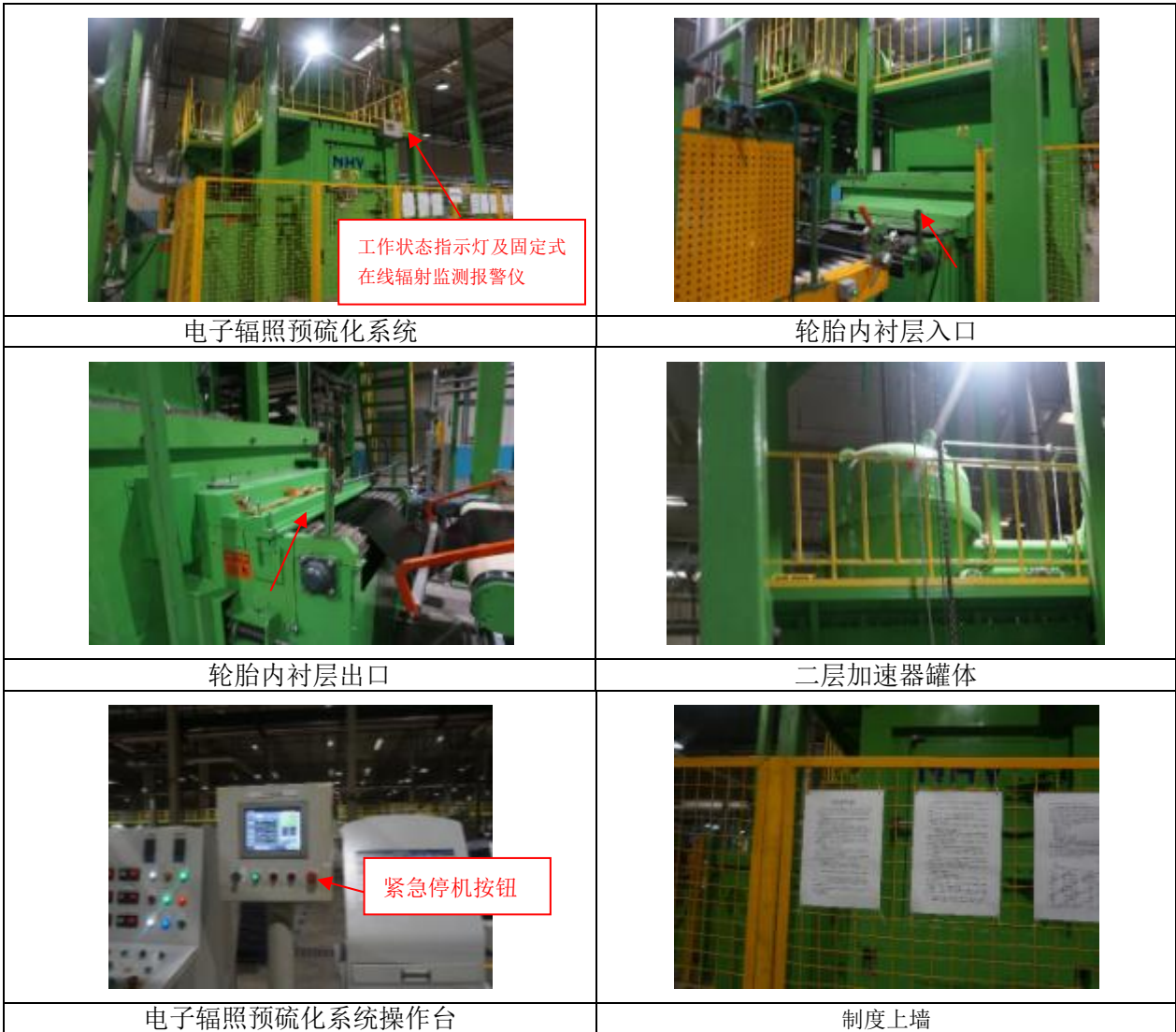
图 2-6 本项目电子辐照硫化系统现场照片
